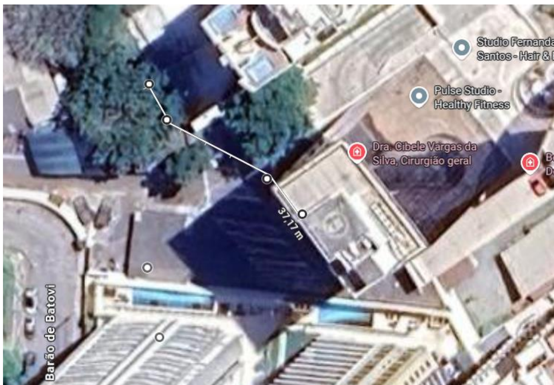
Figura 31 – Distância do local de instalação da câmara fria até o quadro elétrico interno ao pavilhão
