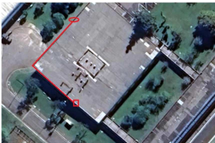
Figura 5 – Distância do local de instalação da câmara fria até a posição do quadro elétrico
