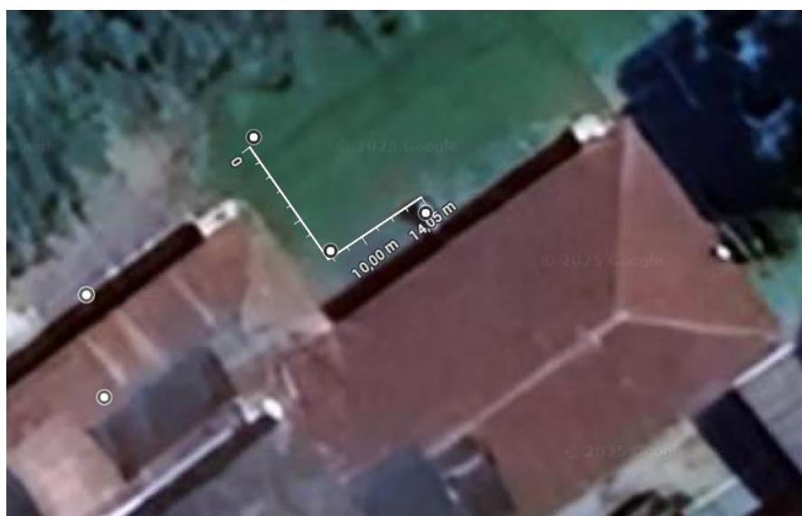
Figura 9 – Distância do local de instalação da câmara fria até a posição do quadro elétrico
